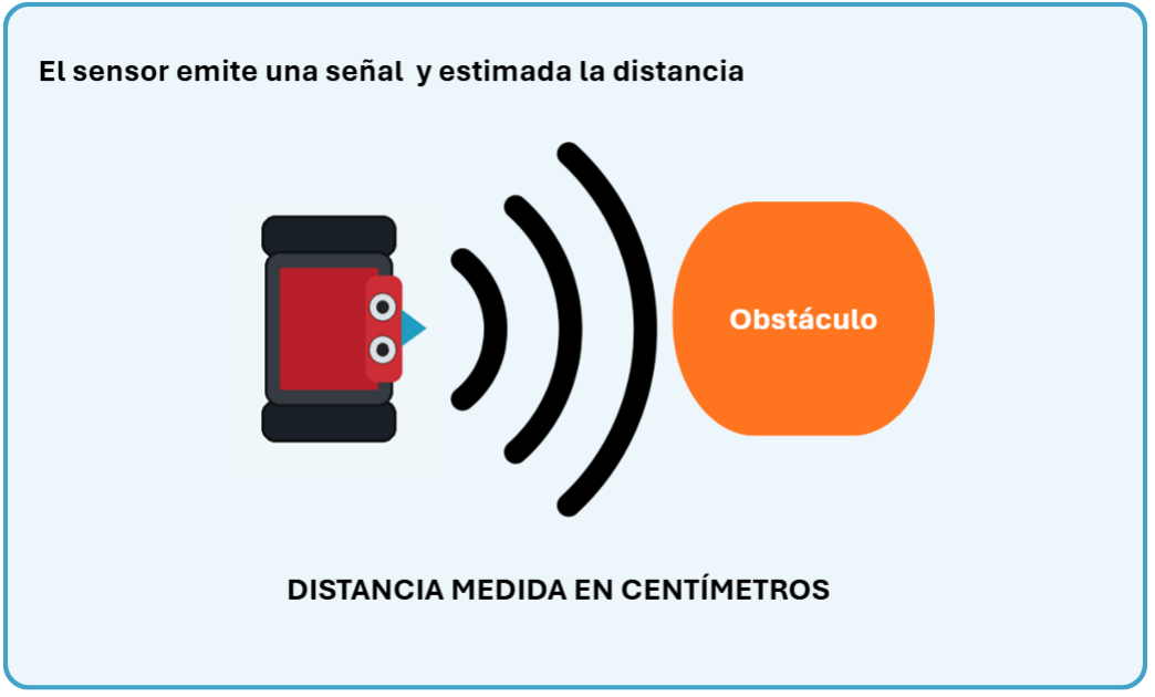
Representación conceptual de la medición ultrasónica frontal.
